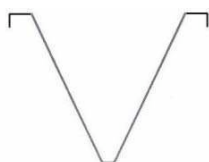
Ángulos de los Flancos Inadecuados
