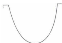
Canal de Polea Totalmente Gastada
