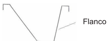
Diferencia en Ángulos de los Flancos
